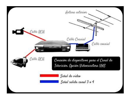
La antena lo instalé en un segundo piso, utilicé un cable coaxial que iba del amplificador a la antena lo más corto posible y utilizando una televisión portátil con antena telescópica pude recibir la señal a una distancia de unos 10 metros a la redonda, pude probar con una televisión analógica con antena exterior y logré visualizar y escuchar la transmisión con algo de interferencia a una distancia de unas 2 cuadras (unos 200 metros aprox.) ¡Una gran hazaña!.
