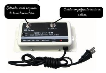
Este amplificador de señal ya no es muy común, pero aún se puede conseguir en tiendas de electrónica. Una vez que hemos conectado la salida de RF de la videocasetera lo conectamos al conector de ANT. (antena) y el otro conector que originalmente iría a una televisión se conecta a una antena externa. He probado con antenas de "conejo" pero las que mejor me han funcionado son las antenas exteriores tipo Yagi:
