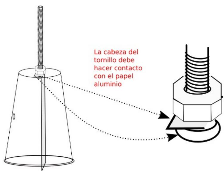
Instalado el tornillo quizá sobre papel aluminio, hay que cortarlo. En ese extremo del papel aluminio colocamos el par de clips fijándolos con la cinta adhesiva.
