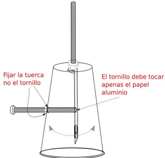
Comenzamos a enroscar el tornillo hasta que toque el papel aluminio, sino llega el tornillo a tocarlo entonces tendrás que ajustar un poco la posición del papel aluminio desatornillando el tornillo superior y volviéndolo a fijar. A continuación realizamos la conexión eléctrica como se muestra en la figura:
