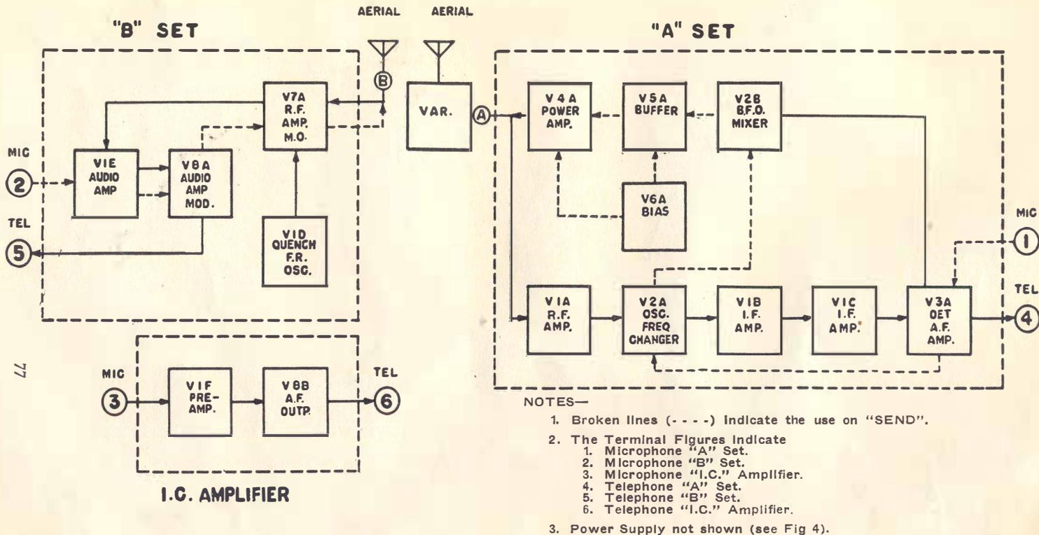
FIG. 1—BLOCK DIAGRAM OF SENDER RECEIVER
