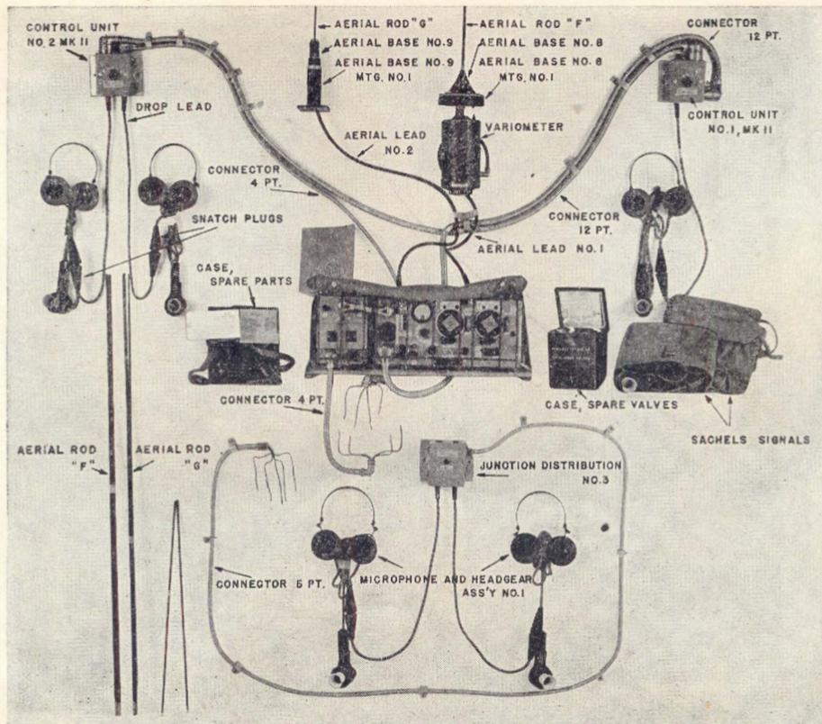
PHOTO 7—INSTALLATION EQUIPMENT FOR U. S. MEDIUM TANK M-4
