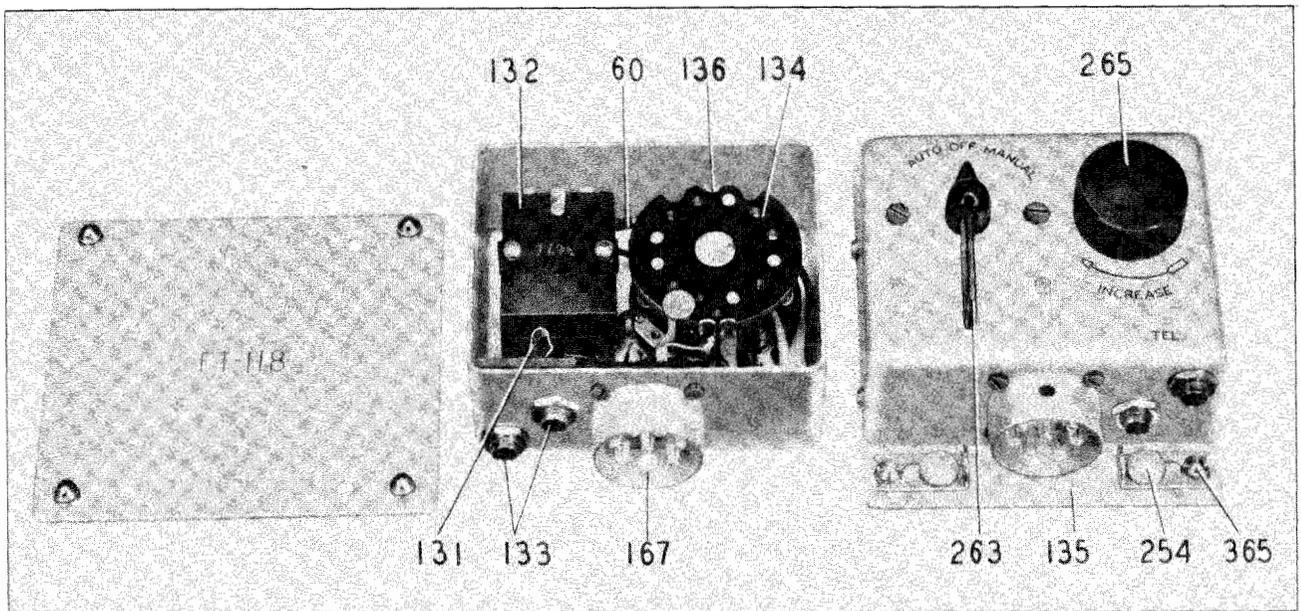
FIGURE 7—RADIO CONTROL BOX BC-AS-231 (RECEIVING)
