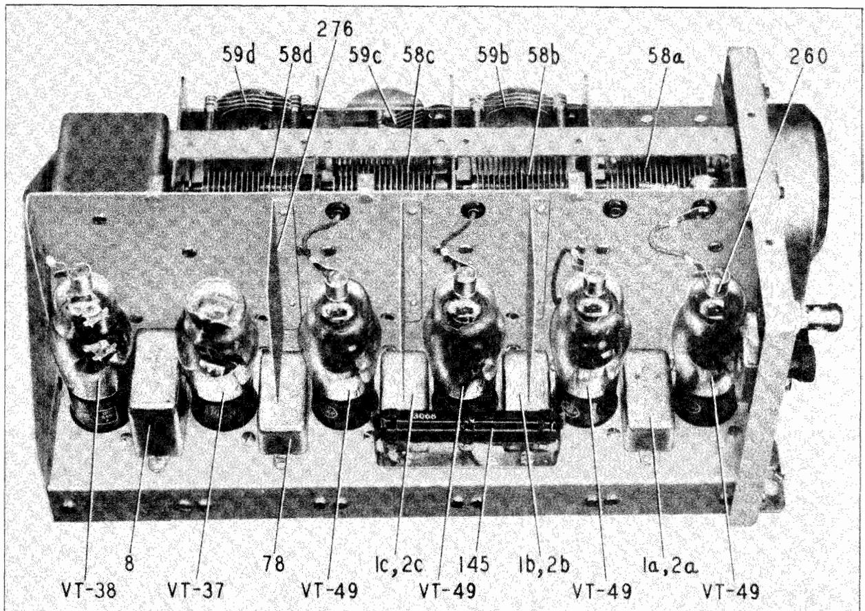
FIGURE 14 - RADIO RECEIVER BC-AS-229, SIDE VIEW
