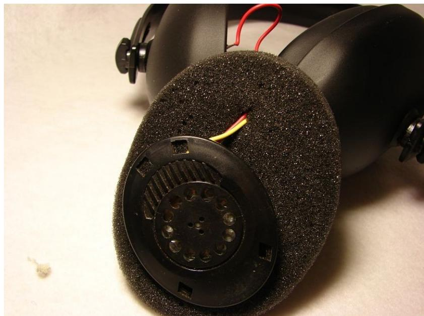
Las conexiones las realicé cortando algunos cables de otro artefacto, pelando las puntas y soldando con cautín y estaño.
