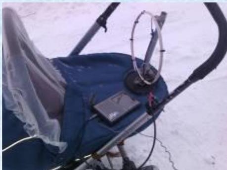
Виктор RU3NJС в любой ситуации находит возможность вести наблюдение за QRP «рандеву». Используя самодельную двухвитковую Magnetic Loop и приемник Degen-1103, Виктор слушает QRP участки 20- и 30-метровых диапазонов не только во время обеденного перерыва на работе, но и во время прогулки с сыном RU3NJС-Junior. Недавно, таким образом, Виктору удалось принять работу Юрия UA1CEG/p (3 Вт) из леса.
