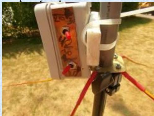
Коробка закреплена на треноге с помощью пластиковых кабельных стяжек. Вместо треноги можно использовать металлическую заостренную трубу, забиваемую в землю. Основа вертикала 6-метровое стеклопластиковое удилище. Внутри удилища пропускается провод активного вибратора длиной 5,1 м. Противовесы 4 шт имеют такую же длину.
