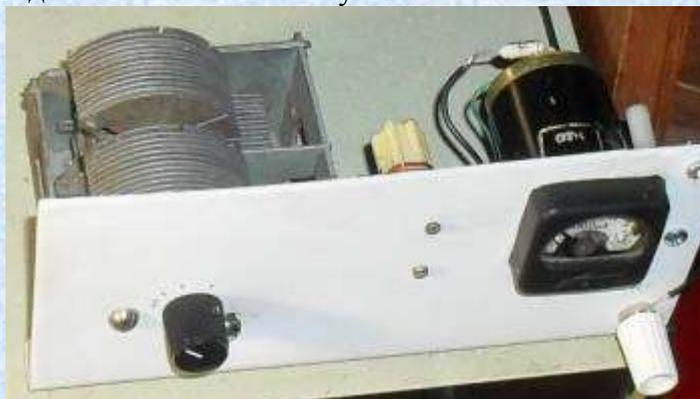
*Резонансный ВЧ пробник*
