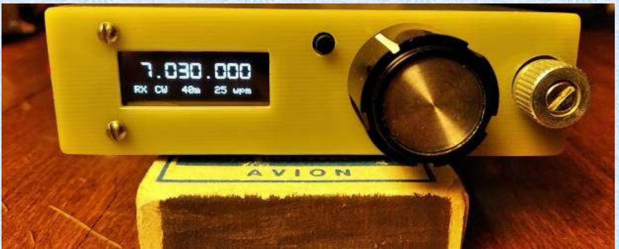
Приемник на базе RX-998 конструкции Алексея UY1IF
