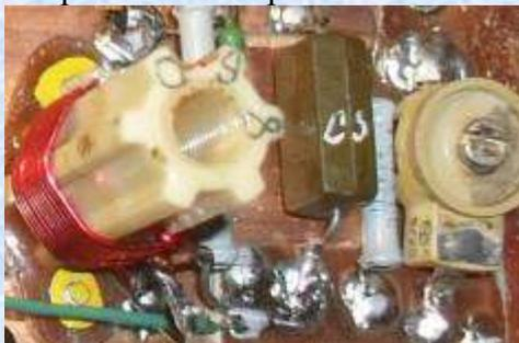
Поскольку я планировал использовать данную конструкцию исключительно для приема очень слабых сигналов телеграфных QRP станций, то не видел смысла применять в ППП систему АРУ. Из схемы я полностью исключил детали R3, R13, С5, С7, V2, V3. А резистор R1 подключил к общей «массе», то есть к «плюсу» питания.
