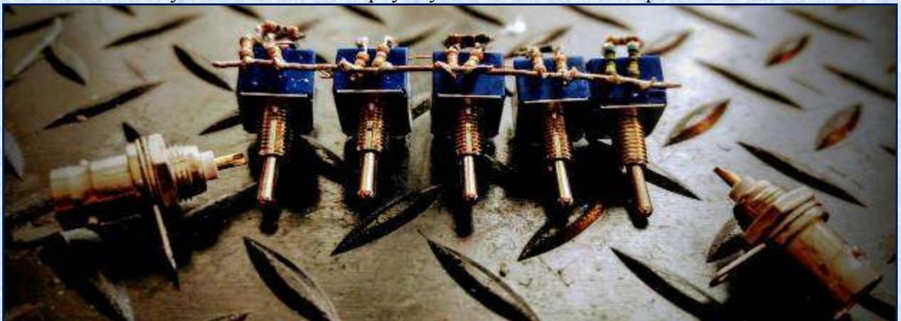
Крис G4UDG поразил коллег изысканным видом своего ступенчатого аттенюатора мощности
