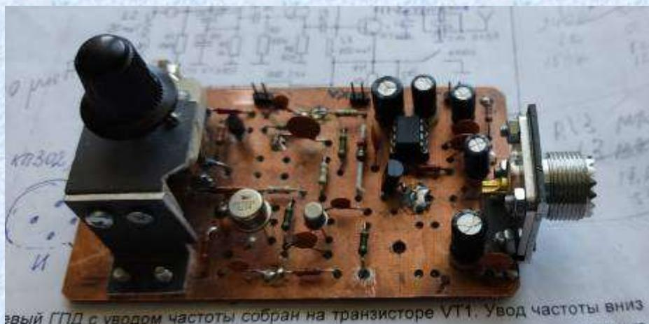
Для использования в качестве КПЕ в VХО Виктору пришлось заняться удлинением оси подстроечного конденсатора, с чем Виктор успешно справился –
