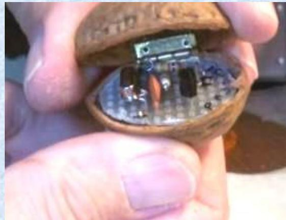
При напряжении 7,6 вольт выходная мощность составила 20...30 мВт. Связей на этом передатчике я пока не провел. Жду более подходящего прохождения.
