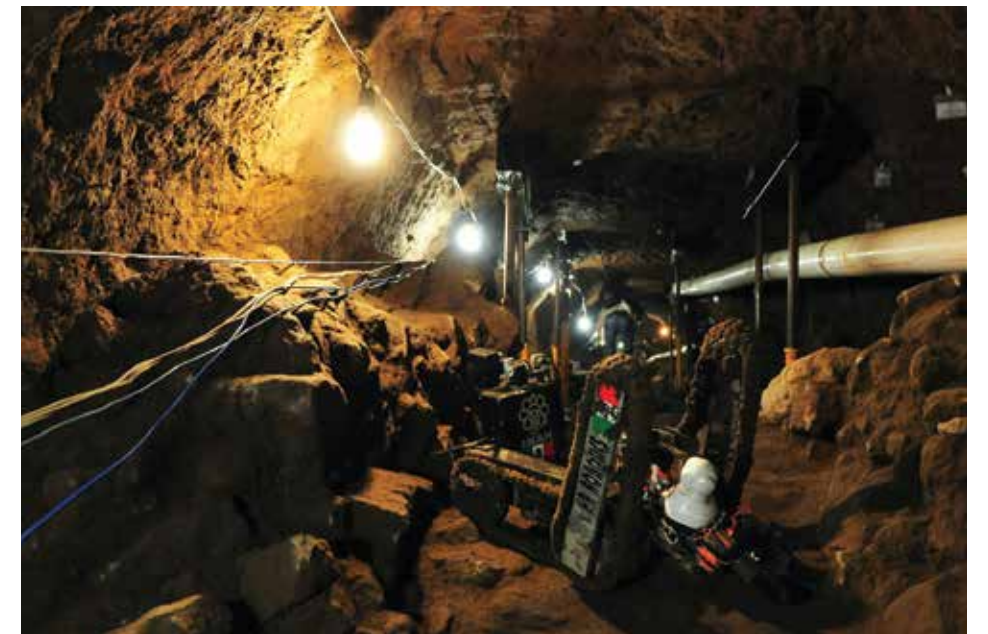
En 2013, el INAH utilizó un robot, denominado Tlálloc II-TC, para recorrer el último tramo que faltaba por investigar de aproximadamente 35 a 40 metros del túnel descubierto en 2003 por Sergio Gómez Chávez (ahora director del proyecto Tlalocan, Camino bajo la tierra) y Julie
