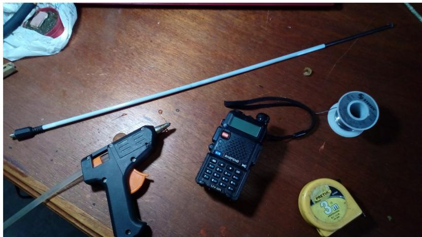
Además utilicé tijeras, pistola de silicón, soldador. Como menciono el adaptador de antena del Baofeng es algo complicado de conseguir en mi localidad, pero adapté un adaptador de una tarjeta de red inalámbrica que ya no servía, sólo invertí la punta interna y funcionó muy bien.
