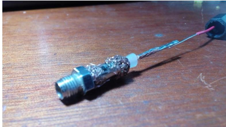
La antena es un trozo de cable delgado que metí adentro de un popote que se utiliza para sostener globos, luego cubrí toda la pieza con tubo termofit para darle consistencia a toda la unidad y un aspecto profesional.
